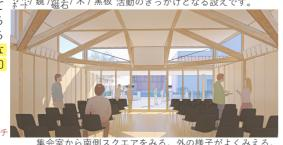
奥まで見通しのよく明るい機能的な建築 (3)(4) 〇司祭館玄関を建物西側に 「〇司祭用の駐車場は専用で動 〇空調は壁掛室内 〇廊下の寝室側に細長い収 〇司祭の寝室を広めに 平面構成は、建築中央の幅 1820 mmの通り芯が1・ 2階の廊下、集会室の構造の中心となっており、南段下を収納とし、収納量を 面庇から廊下の奥まで続き、駐車場までを見通すこ とができます。中廊下型の室配置で諸室を機能的に まとめ、平面外形をシンメトリーの整形とすること で、コストを抑えています。〕階廊下幅は有効 cl±ol 1600 mm以上で段差もないようにすることでバリア フリーに対応し、人が多く集まった際も使いやすい 計画です。また、建築を予算内で木質化し、仕上げ に木材を使用し、居心地の良い空間とします。
